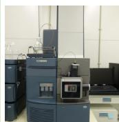
40. 超高速液体クロマトグラフィーシステムを接続してUPLC-MSシステムとして使用可能。ESI(エレクトロスプレーイオン化)プローブとASAP(大気圧固体試料プローブ)の2種類のプローブを選択可能。
