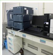
粒子径2μm以下の充填剤を用いることで溶液中の複数の化合物成分の短時間、高精度な分離操作・濃度分析が可能な超高速液体クロマトグラフィー。eλ PDA(190~800nm)、ELS(エバポレイト光散乱)の2種の検出器を選択可能。
