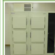
マウス・ラット用の個別型飼育装置(6室)。+5°C~45°Cの範囲で2段変温機能付き。吸気(HEPAフィルタ)・排気(脱臭フィルタ)のバランス調整が可能。各室の照明はタイマーによる昼夜の明暗切替と調光を個別制御可能。
