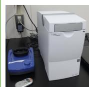
核酸・タンパク質のサイズ測定や定量をオンチップで分析。(専用の試薬キットを用いRNA、DNA、タンパク質、細胞の4つの分析が可能。)また、次世代シーケンサー用DNAサンプルのQCLにも有効。
