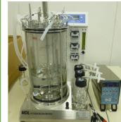
pH、DOの計測及び消泡剤注入の制御が出来るコントローラーを備え付けた10Lの卓上型の培養装置。
