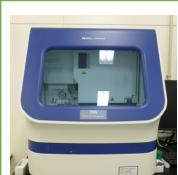
蛍光ジデオキシ法により標識された反応生成物を8本のキャピラリーで同時電気泳動・解析が可能
