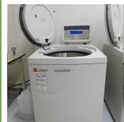
総ステンレス製(ローター:チタニウム)で耐蝕性が高いため、海洋性資源の遠心分離に適している。冷却遠心機能付き。
