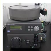
ポンプ・検出器(UV、電気伝導度、pH)・フラクションコレクターを搭載した低圧クロマトグラフィーシステム。流速範囲は0.1~50ml/min、測定UV波長は254、280nm。用途:タンパク質や高分子化合物等の分離・精製
