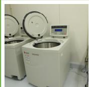
本体にAvanti J-26S XPIを用い、毒性を有する危険物等を扱う場合のバイオハザード対策としてHEPAフィルターが装備されている。冷却遠心機能付き。
