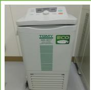
冷却機能付きの遠心機。チューブタイプは2、15、50mlで、最大2ml×72本の大量遠心が可能。96ウェルプレートにも対応している。
