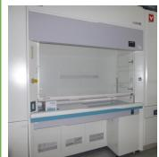
有機系物質を吸着する乾式の排気ガス処理装置を有する作業台。
