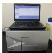
上方・下方蛍光測定、吸光測定、FRET測定など主要な測定方法に幅広く対応している。温度制御により、細胞・生化学アッセイも可能である。吸光測定波長は230~1,000nm
