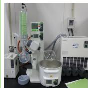
回転数は20～280rpm、恒温水槽の温度調節は室温+5°C～180°Cまで可能。
