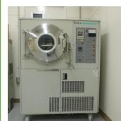
生物試料(植物組織、タンパク質等)の水分を除去する棚式の大型凍結乾燥機。
