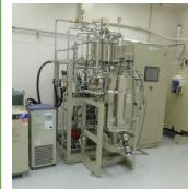
90Lの自動培養装置。藻類や微生物を自動運転で培養でき、培養タンク内のDO、CO<sub>2</sub>濃度・温度・搅拌速度を自動制御することができる。
