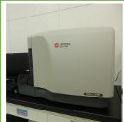
青・赤・紫の3レーザー、10カラーフィルター搭載のセルアナライザー。
