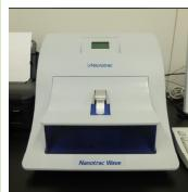
ナノ粒子の物性(粒度分布、ゼータ電位、分子量)測定を行う。ナノ粒子実用化のための分散・凝集特性評価などが可能で、ナノ粒子製剤の基礎研究や製造開発に有用。動的光錯乱法(DLS)および周波数解析(FFT-ヘテロダイン法)で測定。測定範囲は0.8~6,500nm。
