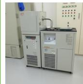
生物試料(植物組織、タンパク質など)の水分を除去する棚式の小型凍結乾燥機。
