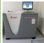
分離・濃縮だけでなく微細粒子沈降などナノテクノロジー分野への研究にも対応可能。
