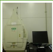
蛍光及び可視染色サンプルのゲルやプロットの撮影解析が可能。高感度の化学発光検出も出来、切り出し時にサンプル・実験者ともに保護するアクセサリーも付属している。冷却CCDカメラ搭載。
