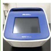
0.1°C単位の温度によるプログラム運転が可能で、異なるアニーリング温度を利用して複数の反応を最大6ラン同時に行える。
