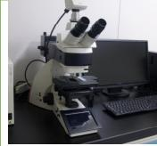
光源にハロゲンランプを使用しており、自動照明コントロール、自動コントラストマネージャー、色温度自動コントロール機能を有する。ローダミン、DAPI、FITCの3種のフィルターを搭載。
